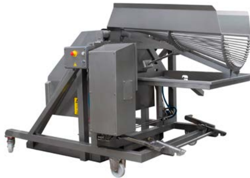
Big Bin Beschickung mit Fleischsaftabführung / Big Bin loader with meat juice discharge
