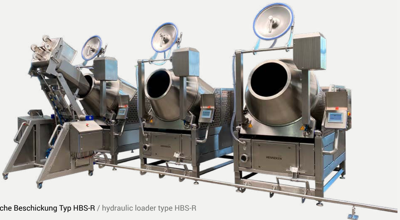
Big Bin Beschickung mit Fleischsaftabführung / Big Bin loader with meat juice discharge
