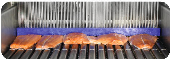
Alta inyección con doble bomba high injector with double pump
